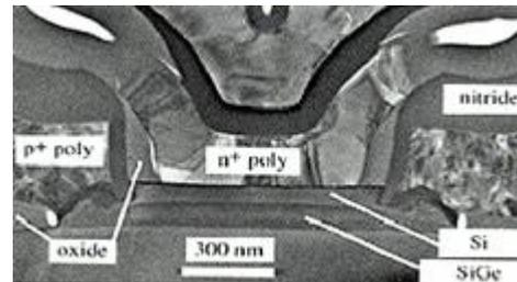
Fig. 1b. Transistor de doble polo (*double-poly transistor*).
