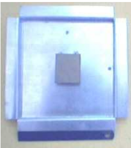
Patch Rectangular en el Aire y su reflector para WLL en la banda de 3.4 a 3.6 GHz.
